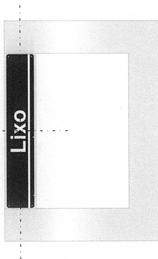
3 DETALHE DE INSTALAÇÃO DA PLACA NO TAMPA DA LIXEIRA
